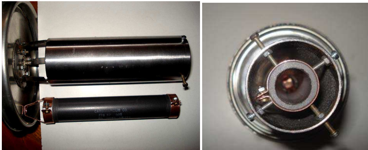
Slika 3: Izdelana koaxialna cev z uporom
